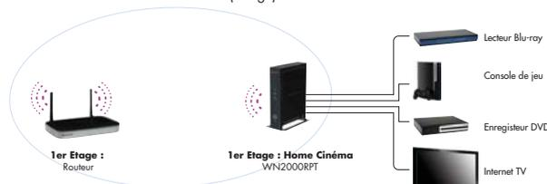
Remarque : Les configurations 1 et 2 peuvent fonctionner en simultanée ; le WN2000RPT peut être à la fois un répéteur de signal et une passerelle réseau. Toutefois, dans ce cas, la connexion wifi pourra se dégrader si le positionnement de l'appareil n'est pas optimal, utilisé comme répéteur.
